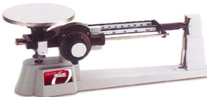
La serie Dial-o-Gram® combina la comodidad de la calibración mediante un dial de lectura directa con la velocidad de la amortiguacion magnetica para lograr una balanza capaz de pesarlo todo con exactitud y rapidez
